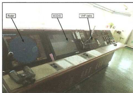
image 5 : D isposition en fer à cheval de la passerelle du King Arthur montrant les écrans utilisés par le commandant et l'officier de quart
