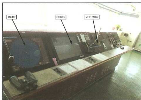
image 4 : Pupitre tribord de l'ANL Wyong montrant les écrans radar et ECDIS utilisés par l'officier de quart
