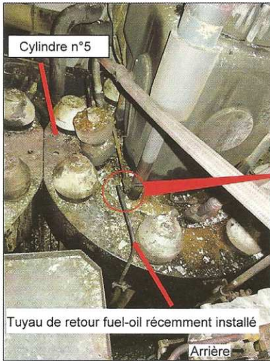
Cylindre n°5 le tuyau déconnecté de retour de fuel-oil récemment installé.
