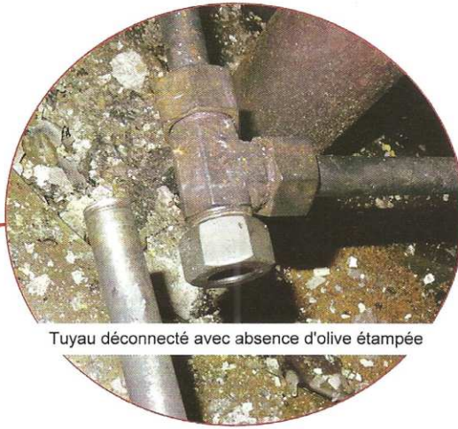
Cylindre n°5 le tuyau déconnecté de retour de fuel-oil récemment installé.
