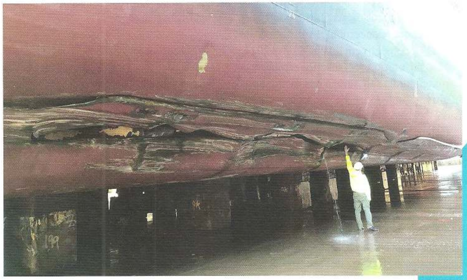
Figure 4: Avaries sur le côté bâbord du Seatruck Performance
