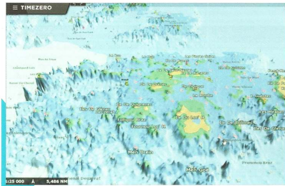
Trois styles de cartographie électronique, tous disponibles sur le logiciel TZ, pour une même zone très fréquentée par les plaisanciers, l'archipel des Glénan. De haut en bas : la carte raster du Shom, la carte vectorielle Navionics classique et la carte vectorielle C-Map, avec représentation en trois dimensions
