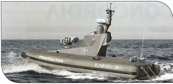
Pour le futur : USV - Unmanned Surface Vehicle
