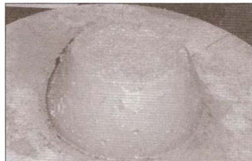
Figure 2 : Changement de forme du cône échantillon après le test, correspondant à une augmentation de diamètre de 6,5mm
