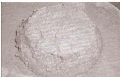
Figure 3 : Cône échantillon après test avec augmentation de 20mm à la base
