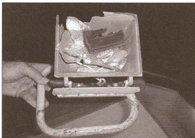
Restes de la lampe halogène non protégée
