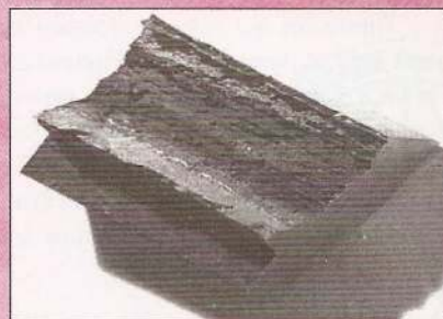
Coupe d'une crique lamellaire typique, montrant les strates poreuses
