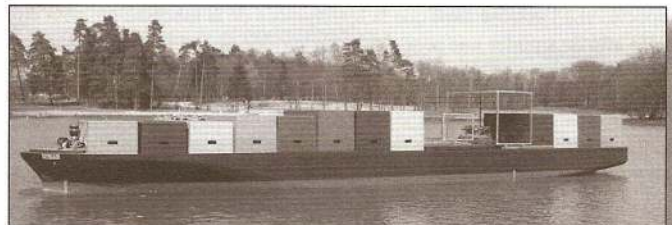
l'Otello, porte-conteneur de 8400 Teus, 334m de long, 42.8m de large, 14.50m de tirant d'eau et une hélice pour 93300 Ch.
