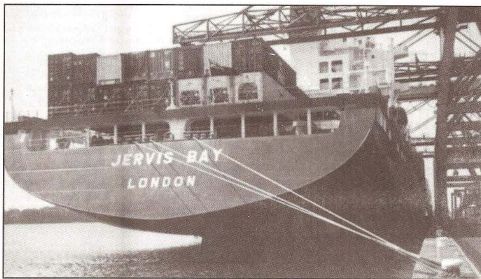
Le maxi des panamax : longueur 292,20 m - largeur 32,20 m. 4 038 EVP. La largeur "Panama" autorise 13 conteneurs par rangée, tandis que, pour l'instant, les «over panamax» en prennent 16.
